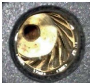
*El resorte de hoja del puerto de carga y la parte inferior de la terminal están amarillentos, y la cola del cable de carga está melanizada y deformada, es necesario cambiarla.*
