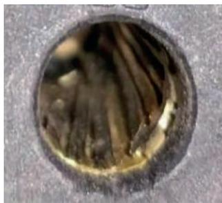
*La ballesta del puerto de carga o parte inferior del terminal está melanizada necesita cambiar.*
